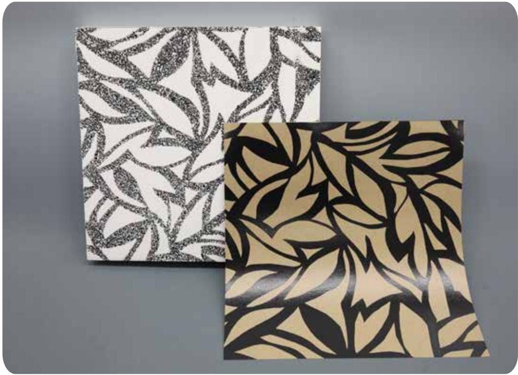
「ベトンフィット」はプレキャストコンクリート専用の加飾工程紙です。特殊なインキで印刷された絵柄の部分がコンクリートの硬化を遅延させることにより、水洗いをすると硬化していない部分が洗い流され、絵柄の凹凸が浮き出てきます。従来の型押し手法と異なり金型が不要なため、工期の短縮が可能になります。
